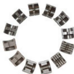
A Matriz é um equipamento que serve de molde para compressão de luvas e conectores de fios e cabos elétricos, é fornecida em pares e de acordo com o índice que é definido pelo cliente em função do tipo de conector que ele irá prensar.
