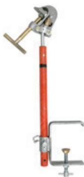
O BASTÃO SUPORTE ISOLADO fabricado com tubo em fibra de vidro e preenchido com espuma poliuretana possui um grampo morça em formato "C" para fixação em cruzetas de até 112 mm de altura. Grampo de aterramento SE4514 fixado na ponta contraria ao grampo morça para fixação do jampe.
